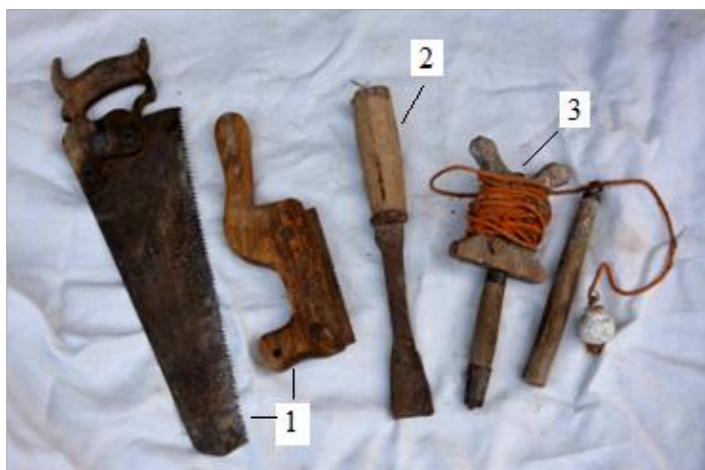
LXIV. 1 – pila, 2 – dłото, 3 – sznur.
