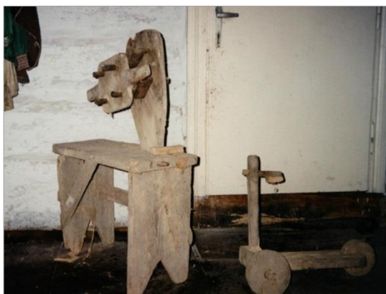
XXVI. Wózek, za pomocą którego skręcano powrozy.
