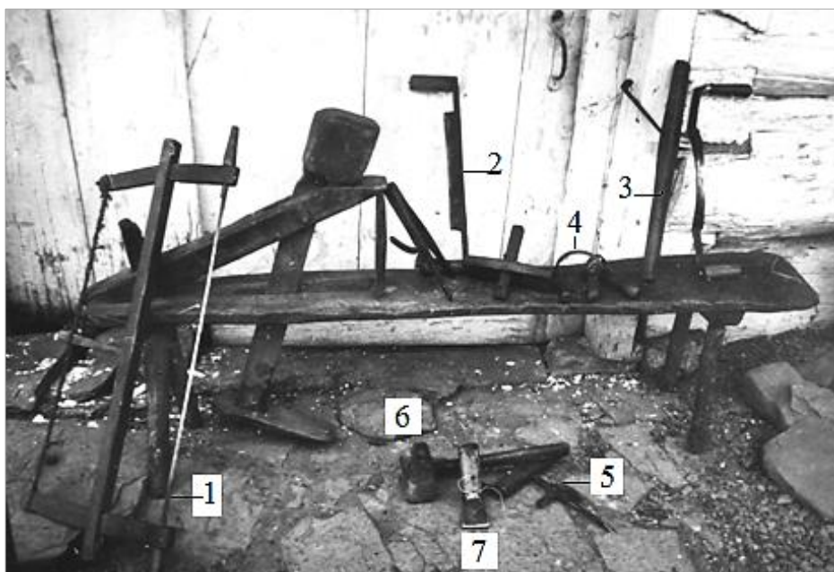
L. Ława stolarsko-bednarska i narzędzia: 1 – pilka ramowo, 2 – ośnik, 3 – cugi, 4 – szapka, 5 – ingor, 6 – młotek drewniany, 7 – dłuto.
