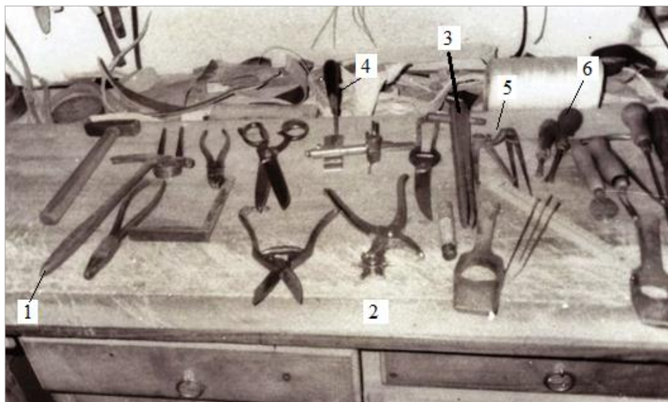
LXIII. Narzędzia wykorzystywane przez rymarza, m.in.: 1 – młotek siodlarski, 2 – druszkok, 3 – skrótka, 4 – nóż rymarzski, 5 – cyrkiel, 6 – szwajki.
