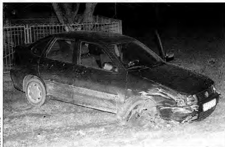
Volkswagen wyrzucony siłą uderzenia na pobocze. Widoczne uszkodzenia maski i rozbite przednie zawieszenie.
