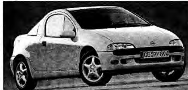
Opel Tigra 1.6 Pojemność 1598 cm sześć., moc 106 KM, maks. moment obr. 202 Nm, przyspieszenie 10,5 s, prędkość 203 km/h
