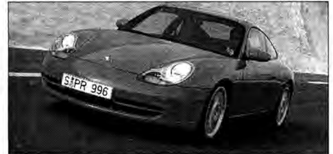
Porsche 911 Carrera Pojemność 2480 cm sześć., moc 204 KM, maks. moment obr. 245 Nm, przyspieszenie 5,2 s, prędkość 280 km/h
