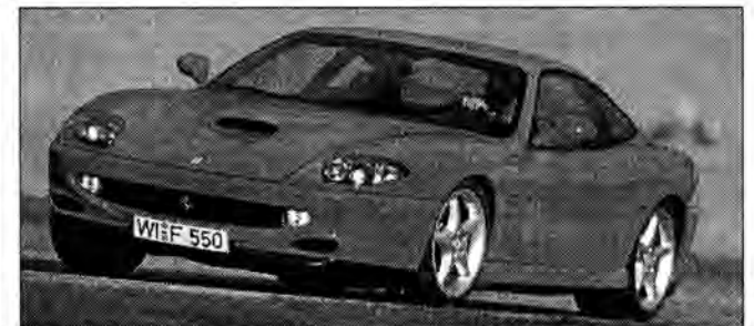
Ferrari 550 Maranello Pojemność 5474 cm sześć., moc 485 KM, maks. moment obr. 569 Nm, przyspieszenie 4,4 s, prędkość 320 km/h
