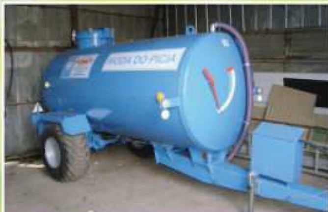
Beczka o poj. 4000 l do przewożenia wody pitnej w przypadku awarii sieci wodociągowej
