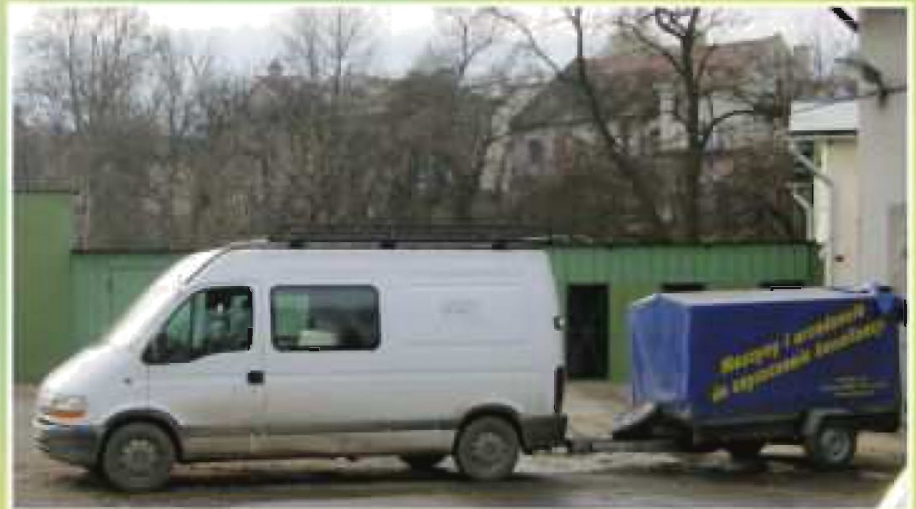
Samochód wraz z urządzeniem ciśnieniowym „Wuko”, służącym do przepychania zatorów kanalizacji
