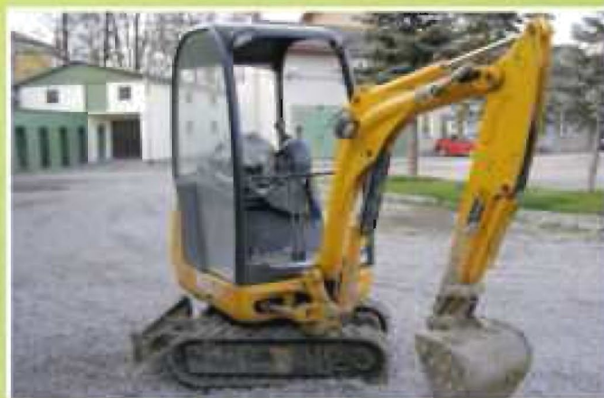
Koparka JCB Mini, służy do usuwania awarii w miejscach trudno dostępnych
