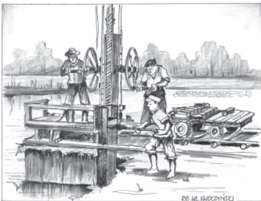
Wydobycie maszynowe za pomocą torfiarki. Rys. Wł. Kwoczyński
